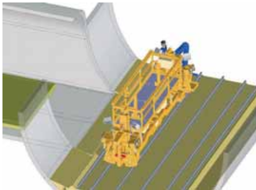
Selbständiges Verschieben der Maschine auf Hauptgleis bis zum nächsten Querschlag
