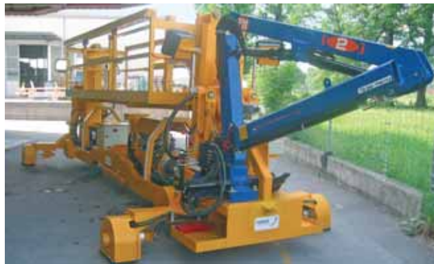
Folienverlegemaschine Querschläge – Werkmontage
