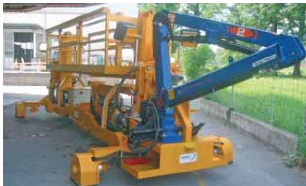
Folienverlegemaschine Querschläge – Werkmontage
