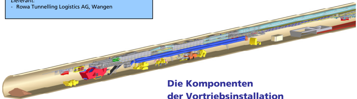
Gesamtansicht des hochmechanisierten Nachlaufsystems
