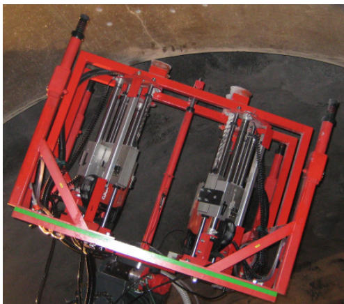
Mit dem allseitig beweglichen Drehkopf am Trägerarm wird das Bohrmodul an der Bohrstelle ausgerichtet und genau zentriert.
