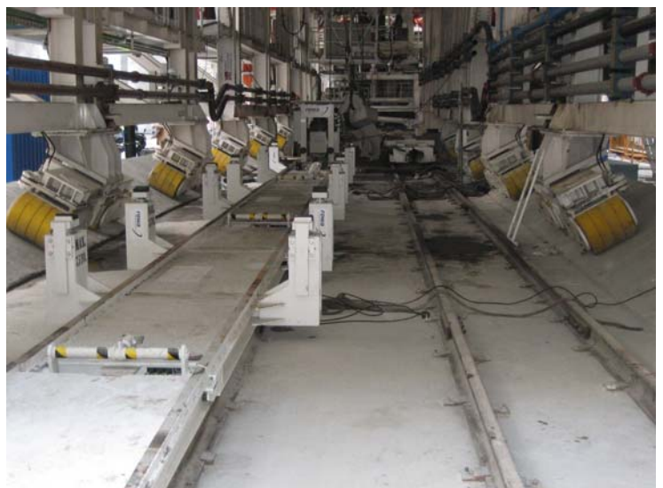
Doppelgleisschnellentladung im Nachläufer
