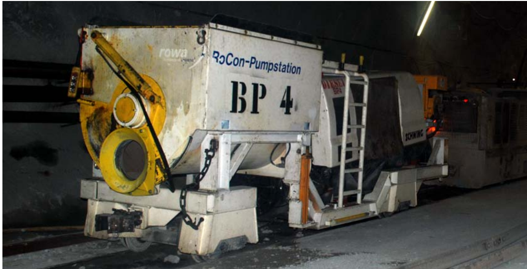
Bild: RoCon Pumpstation
