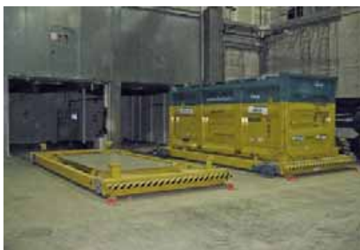
Containertransportwagen mit Waage
