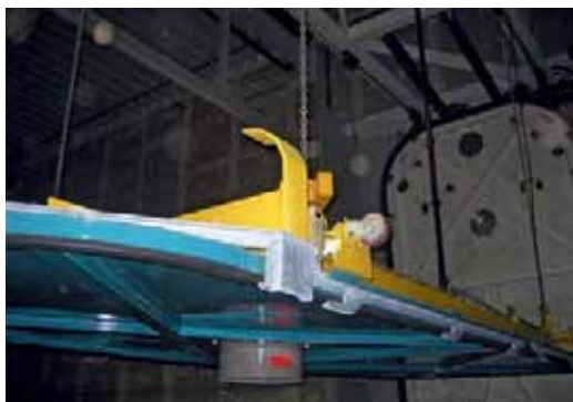
Spreader für Containerdeckel
