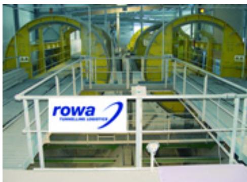
Mit der Rotationskippe Rowa Rotary III entleert der Lokführer einen Zug in weniger als zehn Minuten
