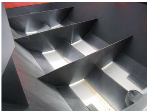
Bodenentleerung in Kiestransportsilo
