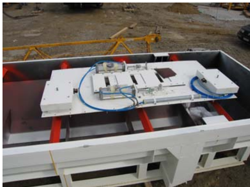
Materialschleusesilo für den Bindemittelumschlag vor Einbau in Nachläufer
