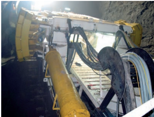
Nachschleppzylinder, Ø 360/180 x 1900, Wandstärke 40 mm
